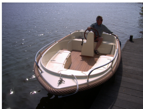
Rhea 450 classic met stuurpaal, teakvloer standaard voorzien van voor- en achterrailing, touwband, opbergbakken in de langsbanken en opstapjes voorzien van teak.
